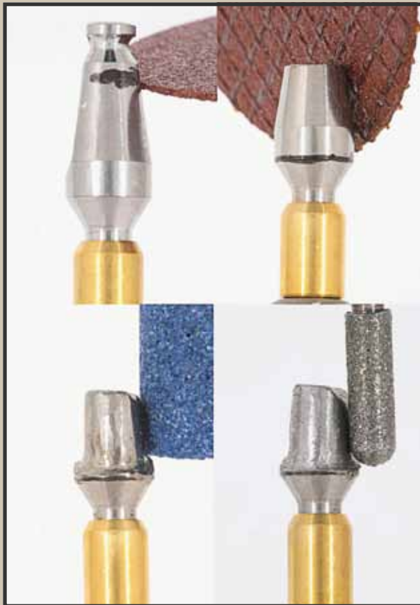
Figura 7, 8 - Preparo e acabamento do munhão de titânio.
