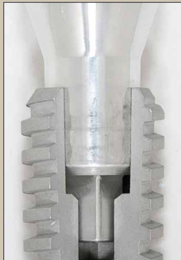
112 113 114 115 116 117 118 119 120 121 122 123 124 125 126 127 128 129 130 131 132 133 134 Figura 1 - Conexão locking taper. Observa-se a união friccional do im- plante com o munhão entre os cones de 1,27^\circ , o índice de posicionamen- to do munhão e a câmara de compensação (espaços apicais).
